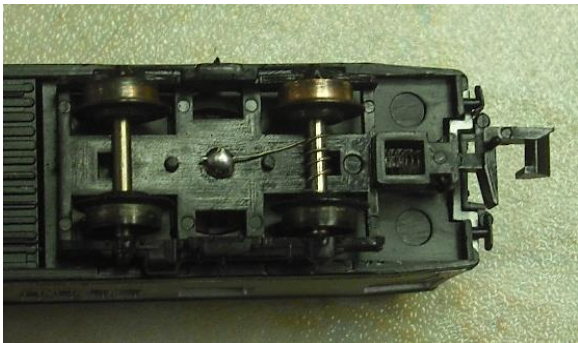
Abb: bedrahtetes Drehgestell mit Nietzapfen
